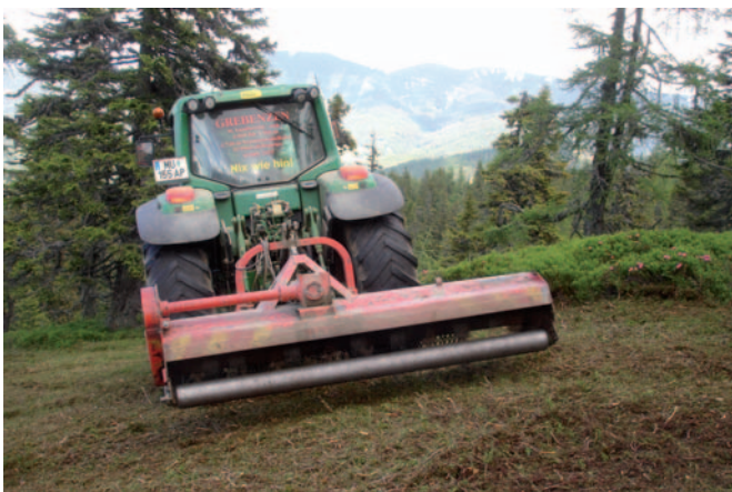
Schlegelmulcher im Einsatz zur Anlage einer Wild-äsungsfläche
